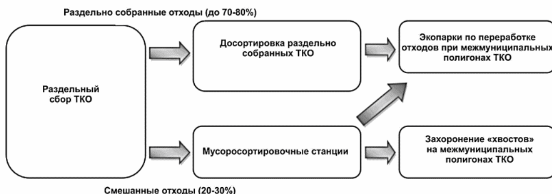
Рис. 9.3.10. Раздельное накопление и сбор ТКО в структуре системы сбора ТКО
