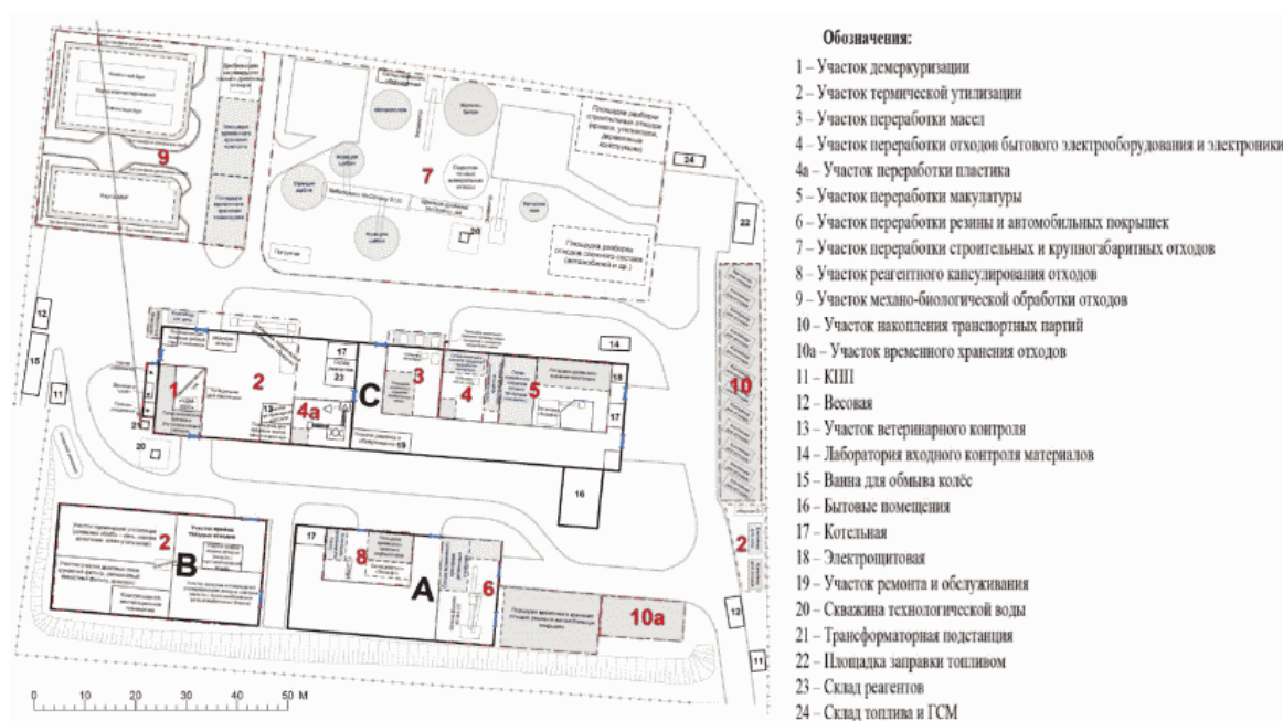
Рис. 10.2.6. Примерный состав технопарка по утилизации прочих отходов
