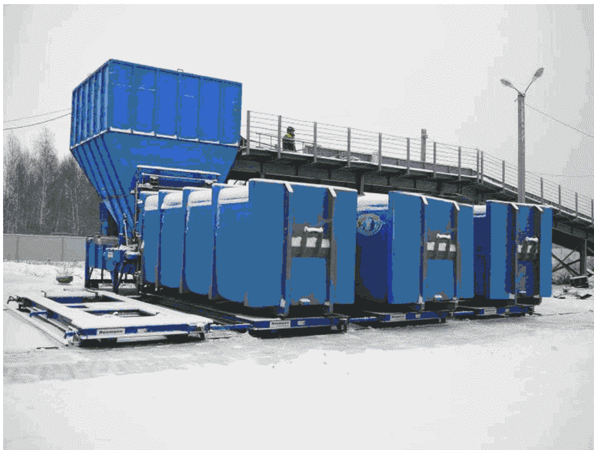
Рис. 10.2.1. Фото общего вида мусороперегрузочной станции
